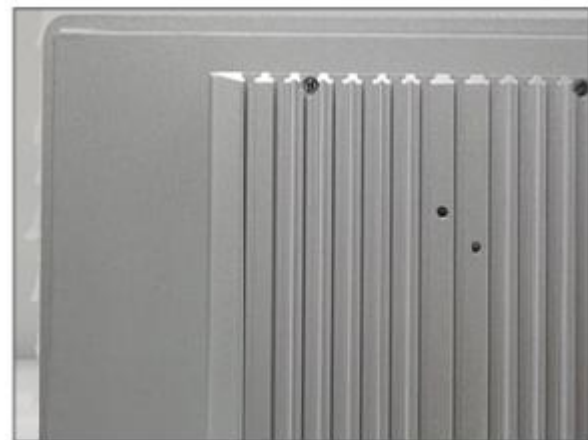
全封闭无风扇散热设计
