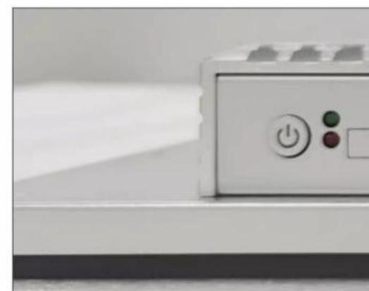
金属电源开关 电源指示灯、硬盘指示灯
